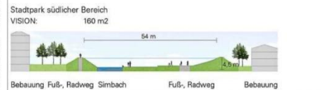
Die beiden Querschnitte zeigen, wie viel Raum man innerhalb des Hochwasserschutzes gewinnen könnte. Oben sieht man den Bereich zwischen Bürgerhaus und Heimatmuseum mit 30 Metern Breite und vier Metern Höhe. Verbauter Raum wären hier im Querschnitt 87 m², jetzt sind es gerade mal 30 m². Der Schnitt unten südlich der Kreuzberger Weg-Brücke könnte sogar 160 m² betragen, im Moment hat der Simbach hier nur 28 m² Raum.
